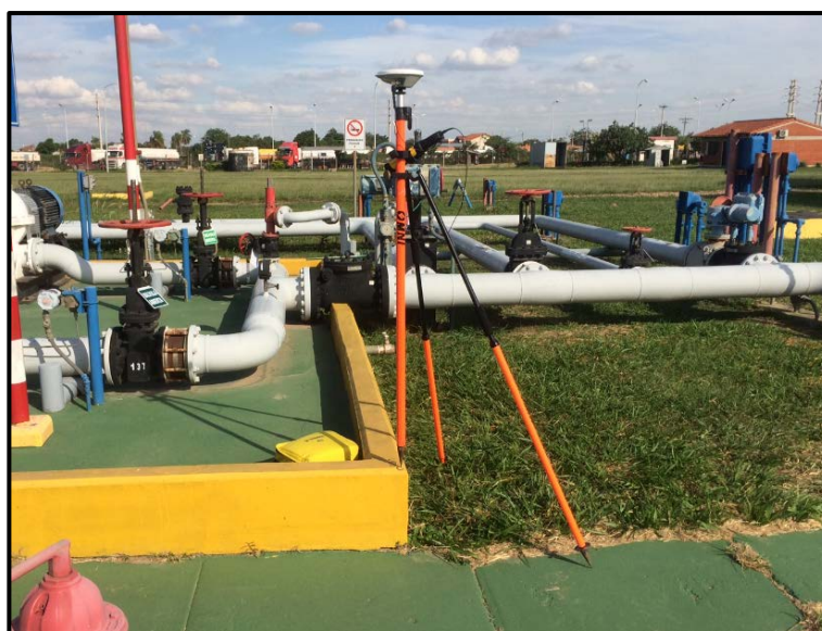
Imagen 5: Lectura con GPS estacionario punto de control AUX-1.
