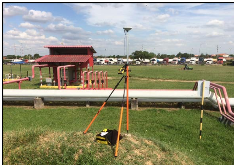
Imagen 4: Lectura con GPS estacionario punto de control M4.
